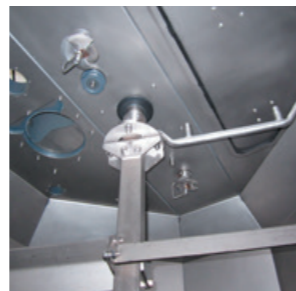
Diamantformet tank sikrer hurtigere og bedre opblanding.
